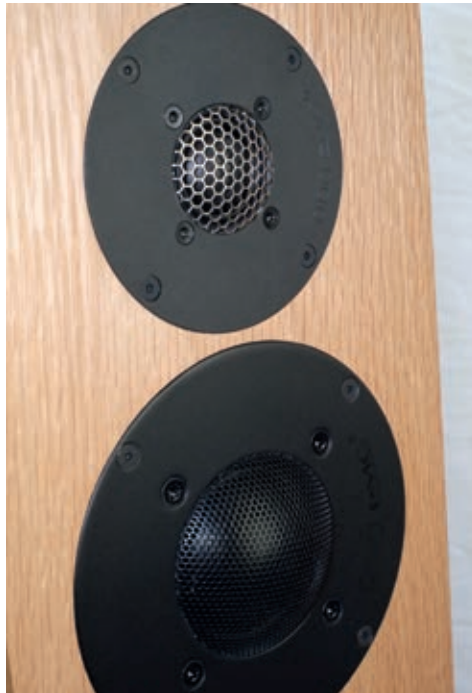
Diskantti- ja keskiäänisen kalottien suojarituloiden rakenteella on merkitystä säteilykuviolle.
